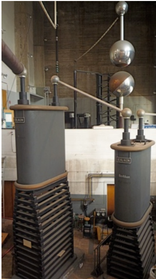
Fig.4 Générateur d'ondes de choc © N. Gesché
