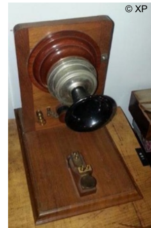
Micro-téléphone. Le manipulateur de type morse permet de passer de la fonction « écoute » à celle d'émission.
