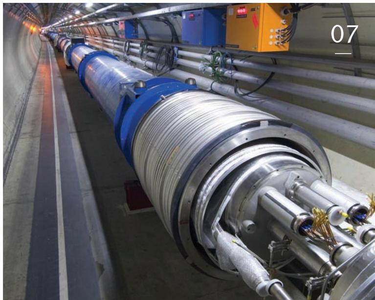
Deux aimants du LHC avant leur connexion. Le cylindre bleu contient la culasse et la bobine de l'aimant supraconducteur ainsi que le système cryogénique à l'hélium liquide. COPYRIGHT CERN
